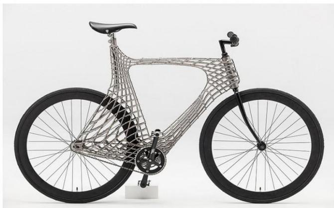
Air Bicycle - Telaio creato con la stampa 3D - Progetto dell'University of Technology of Delft (Olanda) in collaborazione con l'azienda MX3D
